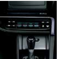
左右独立温度コントロール フルオートエアコン& ピアノタッチスイッチ+ プッシュ式ヒーター コントロールパネル
