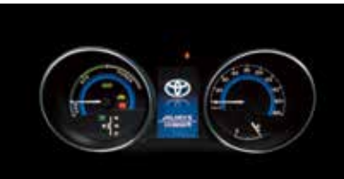
ハイブリッド専用 立体2眼コンビネーションメーター+ TFTカラーマルチインフォメーションディスプレイ (ハイブリッドシステムインジケータ付)
