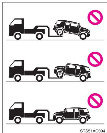
4輪とも持ち上げた状態で運搬してください。タイヤが地面に着いた状態でけん引すると、駆動系部品が破損したり車が台車から飛び出したりするおそれがあります。
