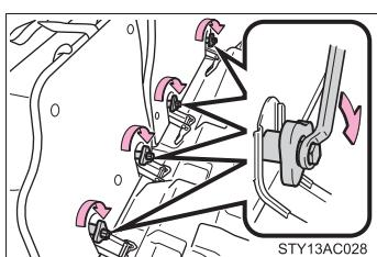
工具を使用し、ボルトを締める
