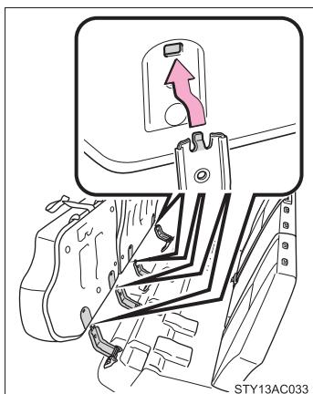
ボルトを取り付ける前に留め金の爪をシートクッション裏の穴にさし込む
