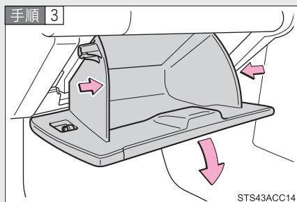
グローブボックスの側面を内側に押してたわませながら上部のツメを片側ずつはずす
