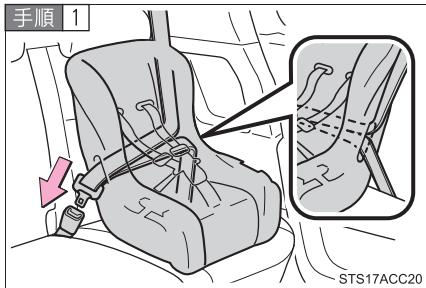
チャイルドシートにシートベルトを取り付け、プレートをバックルに“カチッ”と音がするまで挿し込む。ベルトがねじれていないようにする
