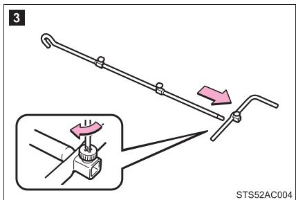
**3 ジャッキハンドル延長バーとジャッキハンドルを組み付け、ネジ部(1カ所)を締め付ける**
