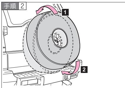
タイヤの上側面からスペアタイヤカバーをかぶせて取り付ける
