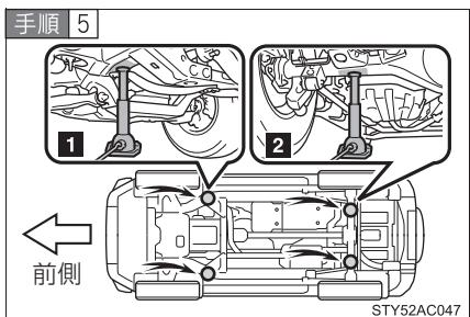
組み付けたジャッキハンドルをジャッキ穴部に挿し込みジャッキセット位置にジャッキをかける
