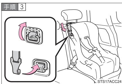
トップテザーアンカーを上げて、アンカーにフックを固定し、テザーベルトを締める
