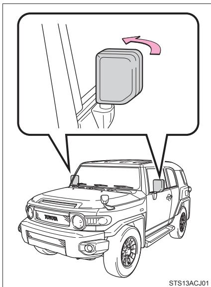
ミラーを手で後方に押して格納する
