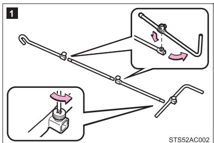
1 ボルト(2本)・ネジ部(1カ所)をジャッキハンドルおよびドライバーを使用してゆるめる
