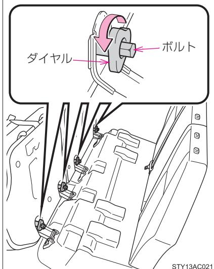
工具を使用してボルトを取りはずす
