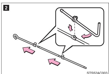
2 ジャッキハンドル延長バーとジャッキハンドルバーを組み付け、ボルト(2本)を締め付ける
