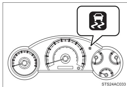
車両が横すべりしそうになったとき、タイヤが空転したときは、VSC・TRC の作動を表示するため、スリップ表示灯が点滅します。
