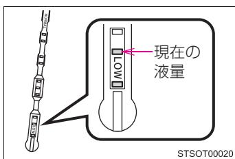
ウォッシャー液の膜が張っているゲージの穴部の位置を確認して、ウォッシャー液の残量を判断します。
