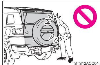
● バックドアステーをロックしていない状態で使用すると、バックドアが突然閉じて重大な傷害を受けるおそれがあります。特に傾斜した場所では、平坦な場所よりもバックドアの開閉がしにくく、急にバックドアが開いたり閉じたりするおそれがあります。バックドアを開けて作業するときは、必ずバックドアステーをロックした状態で行ってください。
