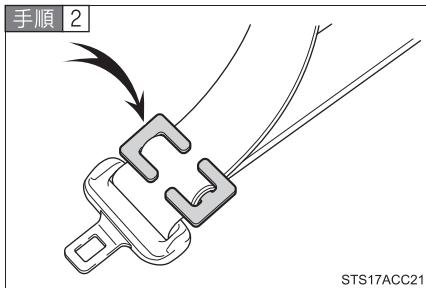
チャイルドシートにシートベルトの固定装置が備っていない場合は、ロッキングクリップ(別売)を使用して固定する
