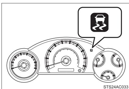
前後輪が空転したときは、アクティブトラクションコントロールの作動を表示するために、スリップ表示灯が点滅します。
