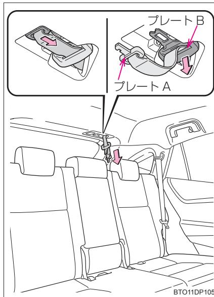
② ベルトを固定するには、プレート A、プレート B の順に“カチッ”と音がするまでプレートをバックルに挿し込む
