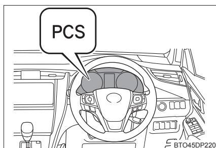
OFF (停止) に切りかえて、プリクラッシュセーフティシステムを停止させた場合、再度、マルチインフォメーションディスプレイの「設定」から「PCS」を ON (作動) に切りかえないとシステムは復帰しません。(パワースイッチの操作では復帰しません)
