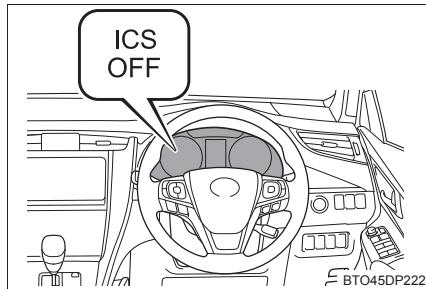
OFF (停止) に切りかえて、インテリジェントクリアランスソナーを停止させた場合、再度、マルチインフォメーションディスプレイの「設定」から「ICS」を ON (作動) に切りかえないとシステムは復帰しません。
