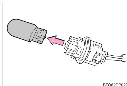
**4 新しい電球を取り付け、ソケットをランプ本体に挿し込み右にまわして取り付ける**
