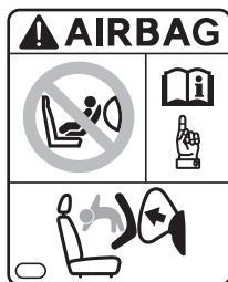
助手席エアバッグの有無にかかわらず、助手席にベビーシートを取り付けたり、チャイルドシートを後ろ向きに取り付けないでください。
