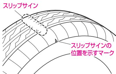
タイヤの溝の深さに不足がないかをスリップサイン（摩耗限度表示）により点検してください。
