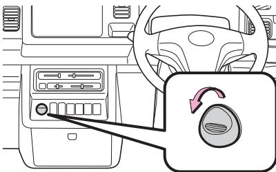
電化製品の電源用ソケットとして利用することができます。
