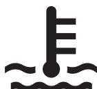
エンジンスイッチが“ON”で、エンジン冷却水温が低いとき、青色に点灯します。
