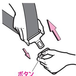
●バックルのボタンを押します。ベルトは自動的に収納されますので、ねじれや引っかかりなどがないかを確認しながら、プレートに手を添えてゆっくり戻します。
