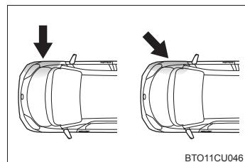
SRS サイド&カーテンシールドエアバッグは、前方や後方からの衝撃・横転・または低速での側面からの衝撃で作動するようには設計されていません。
