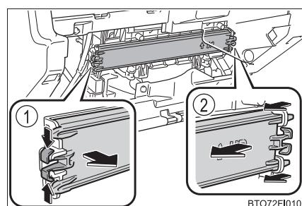
**4** フィルターを取りはずし、新しいフィルターと交換する
