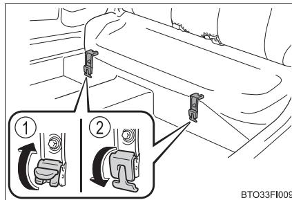
9 シート両端のストラップのいずれか片方を引いてロックをはずし、背もたれを前方に倒す
