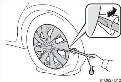
傷が付くのを防ぐため、ホイールナットレンチの先端に布などを巻いて保護してください。
