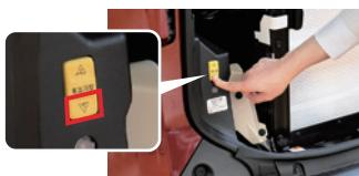
バックドアを開け、車高調整スイッチの「下」を押す
