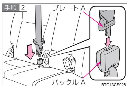
プレート A をバックル A に挿し込み、結合する
