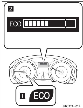
環境に配慮したアクセル操作（エコ運転）の範囲と、現状のアクセル開度を表示します。エコ運転中は、エコドライブインジケーターランプ（1）が点灯します。アクセルの踏み過ぎなど、エコ運転の範囲をこえた場合には、エコドライブインジケーターゾーン表示（2）の右側が点滅し、エコドライブインジケーターランプが消灯します。なお、次の3つの条件を満たすと作動します。
