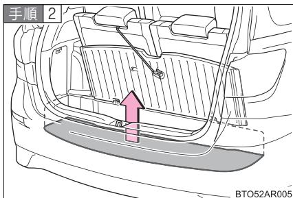
ラゲージルーム後部床上にあるマットの切り欠き部分をめくり、操作ボルトにエクステンションを取り付ける
