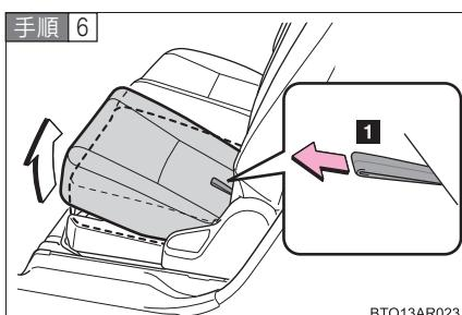
シートクッション後端のシートロック解除ベルト（**1**）を前方へ引き、ロックを解除する
