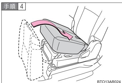
シートクッションの後端部を背もたれの下にもぐり込ませるようにして後方へ倒す
