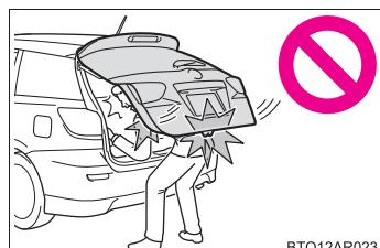
● 半開状態で使用すると、バックドアが突然閉じて重大な傷害を受けるおそれがあります。特に傾斜した場所では、平坦な場所よりもバックドアの開閉がしにくく、急にバックドアが開いたり閉じたりするおそれがあります。必ずバックドアが全開で静止していることを確認して使用してください。
