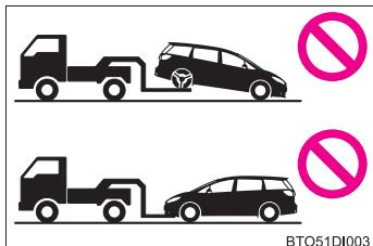
必ず前輪を持ち上げるか、4 輪とも持ち上げた状態で運搬してください。前輪が地面上に着いた状態でけん引すると、駆動系部品が破損するおそれがあります。
