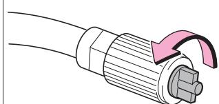
ボトルのホースから空気逃がしキャップを取りはずす
