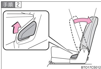
シートをいちばんうしろまで移動させたあと、チャイルドシートを取り付けやすいように、リクライニングレバーを引きながら、背もたれを後方に倒す
