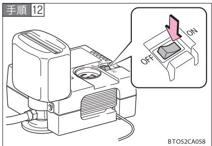
コンプレッサーのスイッチを ON にし、パンク補修液と空気を充填する
