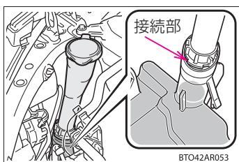
ウォッシャー液を補給する際は、インレットの接続部をこえる位置まで補給しないでください。接続部を超える位置までウォッシャー液を補給すると、接続部からウォッシャー液がもれることができます。
