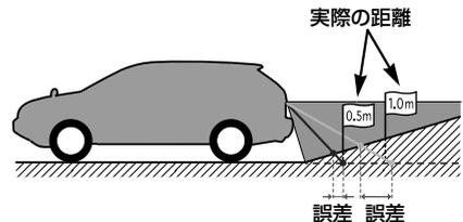
実際の距離より手前に距離目安線が表示されます。そのため、上り坂に障害物があった場合には、実際より遠くにあるように見えます。
