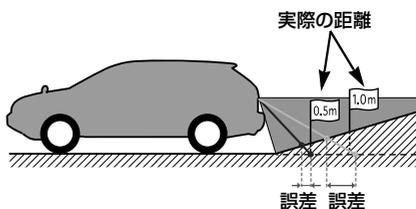
実際の距離より手前に距離目安線が表示されます。そのため、上り坂に障害物があった場合には、実際より遠くにあるように見えます。
