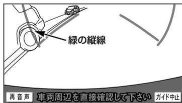
音声案内 「緑の縦線が隣の車のうしろに合うまでバックして止まります。」
