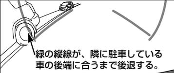
緑の縦線が、隣に駐車している車の後端に合うまで後退する。
