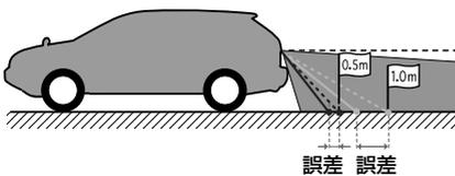
乗車人数、積載量などにより車が傾いているときは、実際の距離、進路と誤差が生じます。
