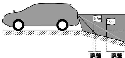
実際の距離よりうしろに距離目安線が表示されます。そのため、下り坂に障害物があった場合には、実際より近くにあるように見えます。
