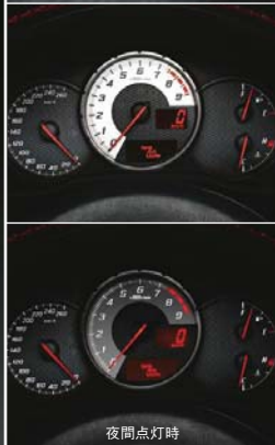
コンビネーションメーター (タコメーター [白文字盤]、 デジタルスピードメーター・ REV インジケーター付)
