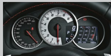
コンビネーションメーター(4.2インチTFTカラーマルチインフォメーションディスプレイ、タコメーター[白文字盤]、デジタルスピードメーター・REVインジケーター付)
