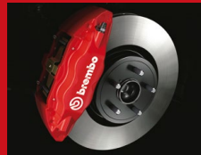
brembo製ベンチレーテッドディスクブレーキ(フロント・リヤ)
