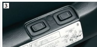
3 シート前後スライドスイッチ&シートリクライニングスイッチ
