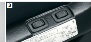
3 シート前後スライドスイッチ& シートリクライニングスイッチ ※車外でのシートリクライニング操作はできません。
