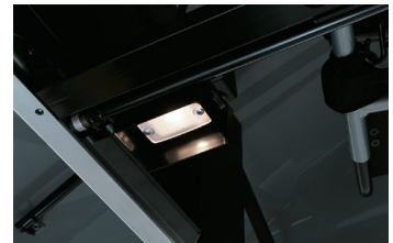
夜間照明灯(ウェルキャリー内側)
