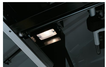
夜間照明灯(ウェルキャリー内側)
