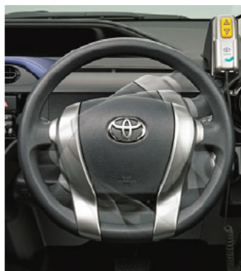
専用パワーステアリング ベース車に比べて発進・低速時のステアリング操作力を50%軽減しています。
