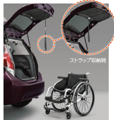
バックドアストラップ 車いすに座ったまま、バックドアを閉める方向に引き寄せることができます。
