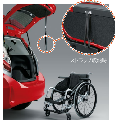
バックドアストラップ 車いすに座ったまま、バックドアを開める方向に引き寄せることができます。
