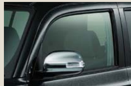
スーパーUVカット・IRカット機能付グリーンガラス(フロントドア)
