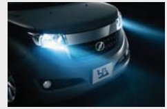
ディスチャージヘッドランプ (オートレベリング機能付) &LEDクリアランスランプ
