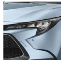
3灯式LEDヘッドランプ+LEDターンランプ+LEDクリアランスランプ
