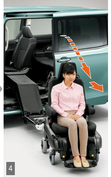
3 車輪が接地すると、シートは脱着可能になります。
