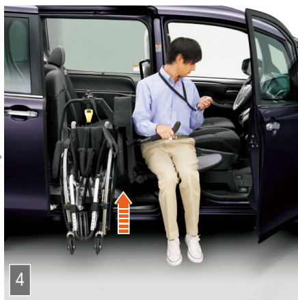
4 移乗シートを運転席の高さまで上昇させます。
