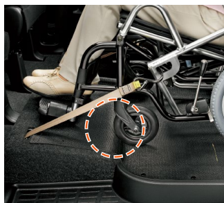
⑥車いすの前輪が車輪止めに到達したら、車いすを止めます。セーフティベルトにより、車いすの前側が固縛されます。
