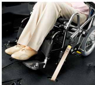
⑥車いすの後輪中央を床面のマークに合わせ、車いすを止めます。セーフティベルトにより、車いすの前側が固縛されます。
