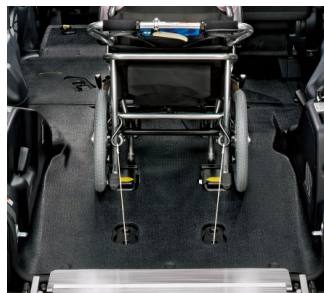
⑦車いすのブレーキをかけ、後側の車いす固定装置(電動)のフックを取り出し、車いすの後部フレーム(左右2ヶ所)に掛け、電動で固縛します。
