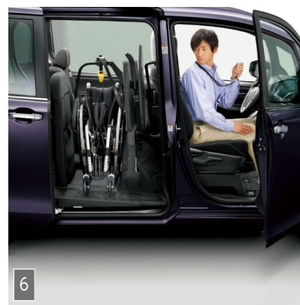
6 リモコン操作でウェルライドを収納し、運転席側パワーシールドドア・運転席ドアを閉めます。
