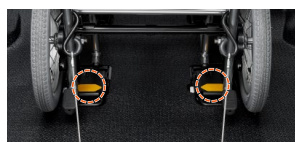
車いす固定マーク
