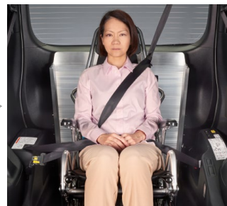
⑧車いす用シートベルトを着用します。スロープを格納し、車高調整スイッチの「上」を押し、車高復帰します。(上がりきると自動停止します)
