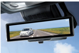
電子インナーミラー 後方の画像をインナーミラーに表示。
