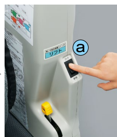
操作スイッチを押して、車いすを電動式のワイヤーでしっかり固定します。
