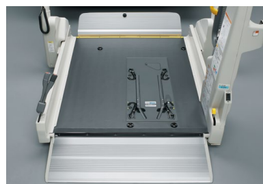
車いす固定用フック付のサポートバーは、リフトおよびフロア上にすっきり格納されています。
