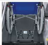
e:後側ワイヤー式/電動(リフト上) ※サポートバーは装着されません。
