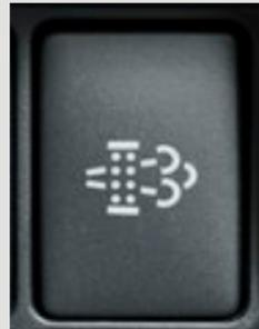
●排出ガス浄化スイッチ(排出ガス浄化を手動で再生させる場合に使います。通常は自動で行われます。)
