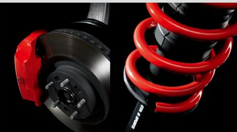
G's専用対向4ポッドキャリパー (レッド塗装/G'sロゴ付/スポーツブレーキパッド付/ベンチレーテッドディスク) ※リヤはフローティングキャリパーとなります。
