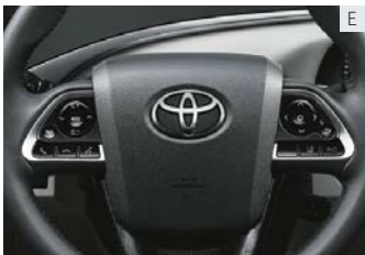
ステアリングスイッチ (ディスプレイ切替く4方向スイッチ・オーディオ・音声認識・ハンズフリー・車間距離切替・レーンディパーチャーアラート)
