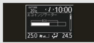
マルチインフォメーションディスプレイ (3.5インチモノクロ)
