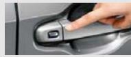
ワンタッチスイッチ付助手席側パワースライドドア(デュアルイージークローザー付)
