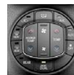
フロントオートエアコン (左右独立温度コントロール+ 蓄冷エバポレーター付)
