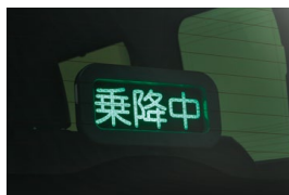
乗降中表示器 助手席側スライドドア開閉時、後続車に注意喚起。
