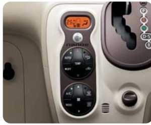
オートエアコン(花粉除去モード付)&プッシュ式ヒーターコントロールパネル&「ナノイー」
