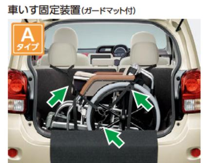
上右側の固定ベルトと下側の固定ベルトをつないだ後、上左側の固定ベルトフックを引にかけて固定します。
