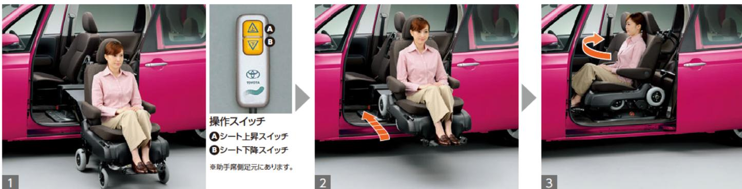
1 スライドドアを全開にし、操作スイッチの下降スイッチを押し続けて、サイドアクセスユニットを引き出し、脱着シートをセットします。
