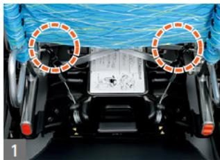
専用車いす固定装置をサイドアクセスユニットにセットし、フックを車いすに掛けます。
