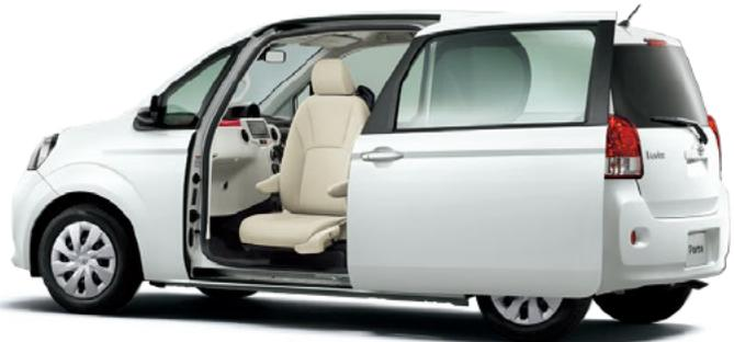
Photo: F 2WD 助手席回転チルトシート車“Aタイプ”。
