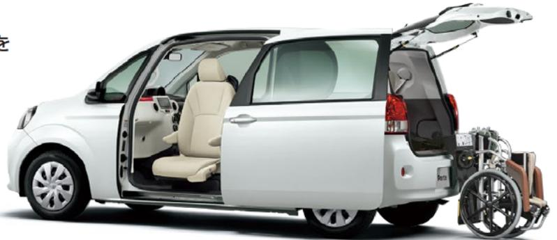
Photo: F 2WD 助手席回転チルトシート車“Bタイプ”。
