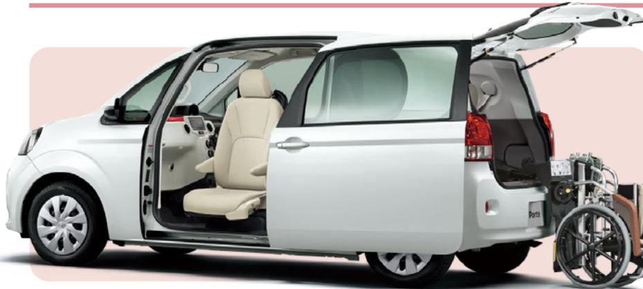
Photo: F 2WD 助手席回転チルトシート車「Bタイプ」。
