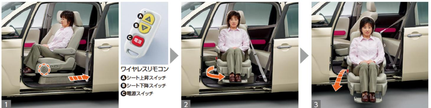
1 スライドドアを全開にして、ワイヤレスリモコンスイッチ(または、シート昇降スイッチ)を押し続けると、回転開始位置までシートがスライドして、背もたれ角度を自動的に調整します。
