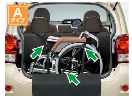
上右側の固定ベルトと下側の固定ベルトをつないだ後、上左側の固定ベルトフックを引っかけて固定します。
