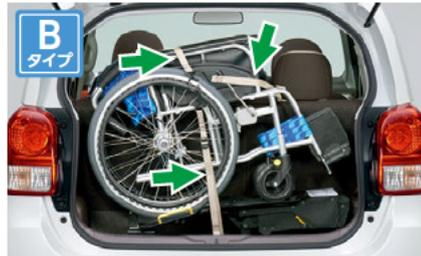
上右側の固定ベルトと下側の固定ベルトをつないだ後、(ガードマット付)
