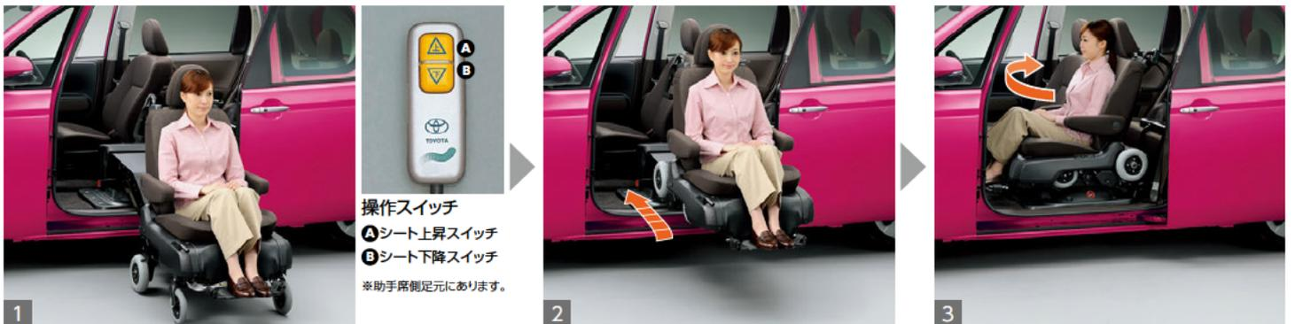
1 スライドドアを全開にし、操作スイッチの下降スイッチを押し続けて、サイドアクセスユニットを引き出し、脱着シートをセットします。
