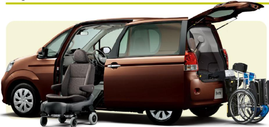
Photo: X 2WD サイドアクセス車 [脱着シート仕様「Bタイプ」(手動式)]. ボディカラーはダークブラウンマイカメタリック(4U3).
