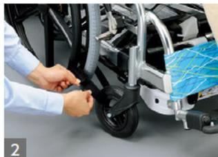
固定用ベルトで専用車いすの前輪を固定します。
