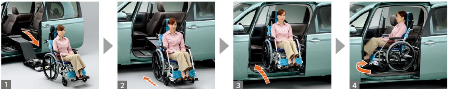
1 スライドドアを全開にし、操作スイッチの下降スイッチを押し続けて、サイドアクセスユニットを引き出します。
