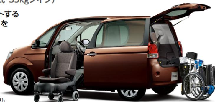
Photo: X 2WD サイドアクセス車 [脱着シート仕様「Bタイプ」(手動式)].
