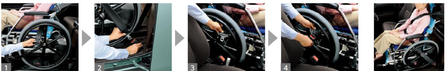
1 シートベルトを引き出して、左側のアームレストの下側と車輪の中(スポークの間)を通します。
