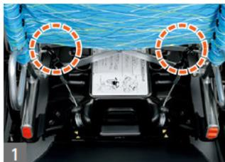
専用車いす固定装置をサイドアクセスユニットにセットし、フックを車いすに掛けます。
