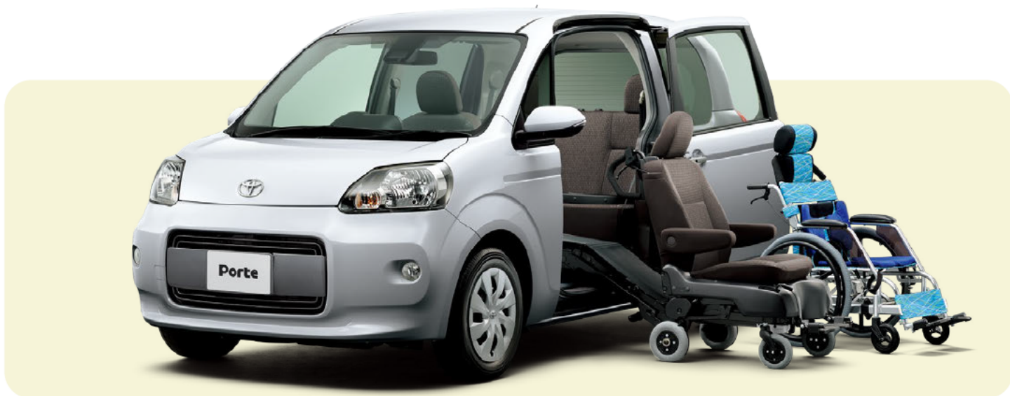
Photo:X 2WD サイドアクセス車[脱着シート(手動式)+専用車いす仕様]。ボディカラーはシルバーメタリック(1F7)。内装色のプラムは設定色(ご注文時に指定が必要です。指定がない場合はフロアマージュになります)。
