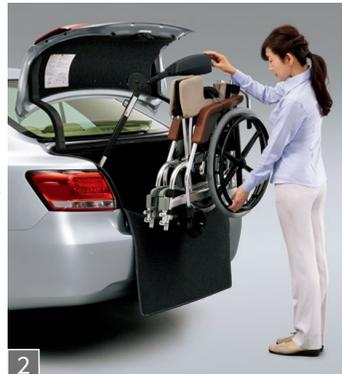
2 スイッチ操作により、電動で車いすを吊り上げ、アームごと回転させトランク内に入れます。
