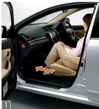
助手席ドアを全開にして、スライドレバーを上方に引き上げ、シートを最前端までスライドさせます。
