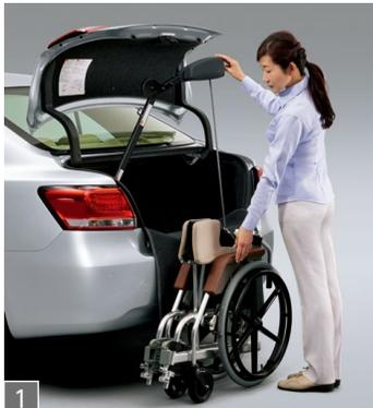
1 ガードマットを取り付け、収納装置のアームを車外に向けてから起こし、吊りベルトを車いすに掛けます。
