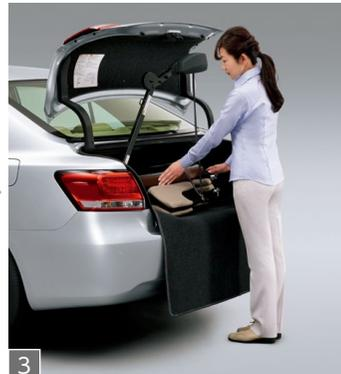
3 収納装置の吊りベルトをゆるめ、収納ボード上を滑らせながら車いすをトランク内に収納します。
