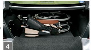
4 車いすを固定装置(ベルト)で固定し、収納装置のアームをたたみ、ガードマットを収納します。
