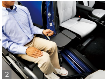
2 移乗ボードを伸ばし車いすの左側フレームに掛けて、車いす固定用ストラップで固定します。
