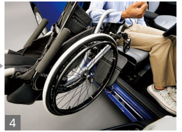
4 移乗ボードは、車いすを車内に収納する際にスロープとして使用できます。(タイプIIの場合)
