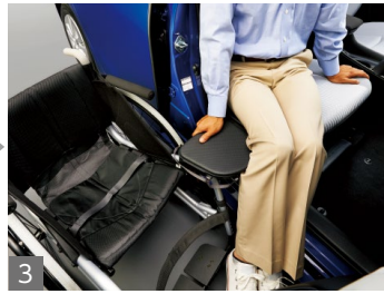
3 移乗ボードを利用して、車いすから運転席へと移乗します。
