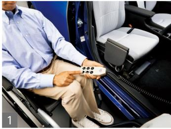
1 リモコンを操作してシートを最後端まで移動します。
