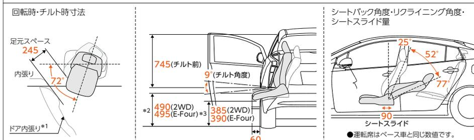
\*1.フロントドアの開閉角度は63°(ベース車と同じ)です。 \*2.シートの座面高は、チルト時の座面中央最高部までの寸法です。
