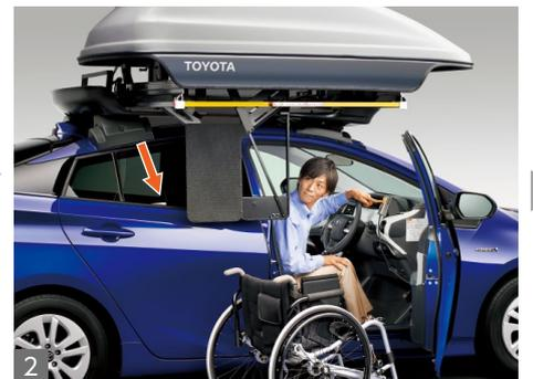
ユニットが停止した位置から再度リモコンスイッチの「下」を押し続けると、ボディ保護のプロテクターと吊りベルトが下降します。
