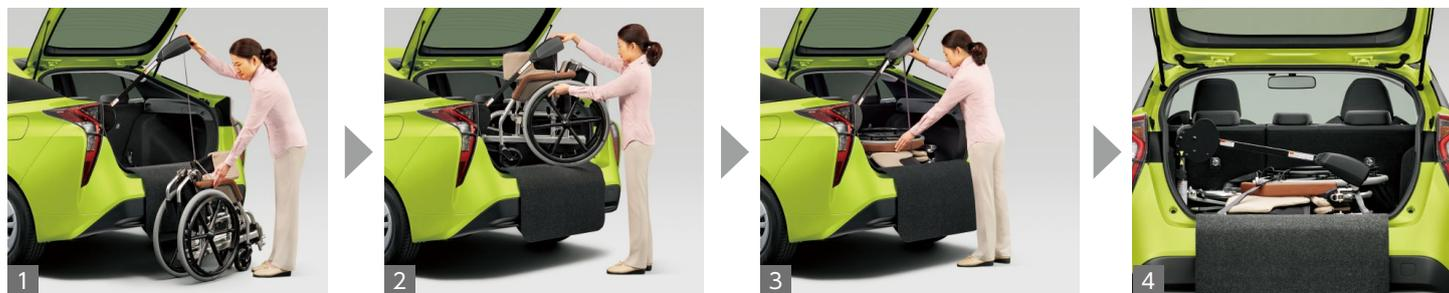
ガードマットを取り付け、収納装置を車外に向けアームを起し、吊りベルトを車いすに掛けます。
