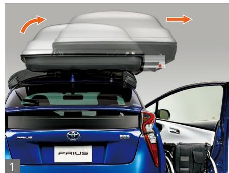
リモコンスイッチの「下」を押し続けると、ウェルキャリアーの上部が約120mmポップアップ。ユニット全体が横スライドし、一旦停止します。
