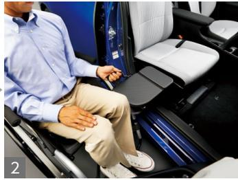
2 移乗ボードを伸ばし車いすの左側フレームに掛けて、車いす固定用ストラップで固定します。
