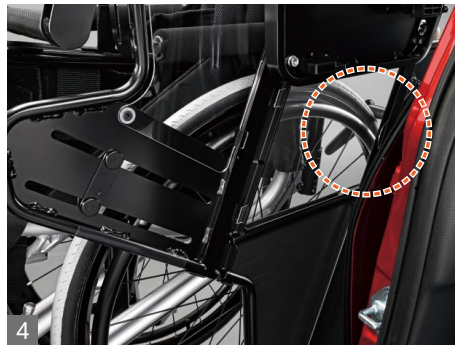
4 車いすの後輪がセーフティガイド内に収まっていることを確認してください。
