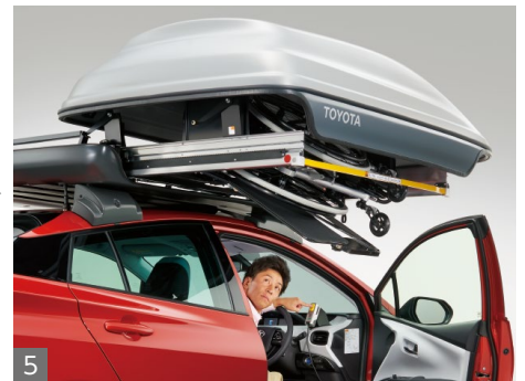
5 さらにリモコンスイッチの「上」を押し続けると、車いすはプロテクターとともにユニット内に収まり、その後ルーフ上に収納されます。
