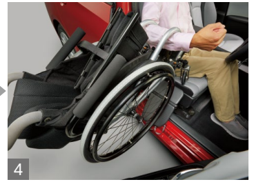
4 移乗ボードは、車いすを車内に収納する際にスロープとして使用できます。(タイプⅡの場合)
