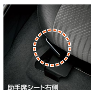
助手席シート右側 スライドレバー 運転席側からも前後スライド操作が可能です。
