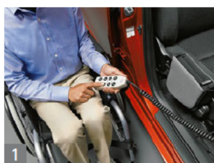
1 リモコンを操作してシートを最後端まで移動し、座面を最下端まで下げます。
