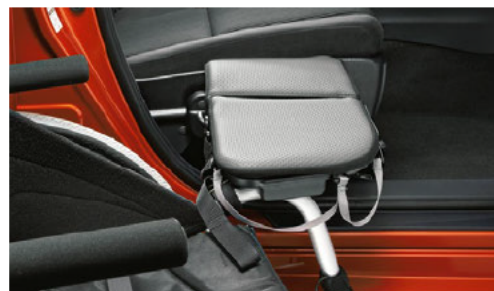
②移乗ボード 格納されている移乗ボードを外側に開き、車いすに固定します。車いすからシートへの乗り移りをサポートします。
