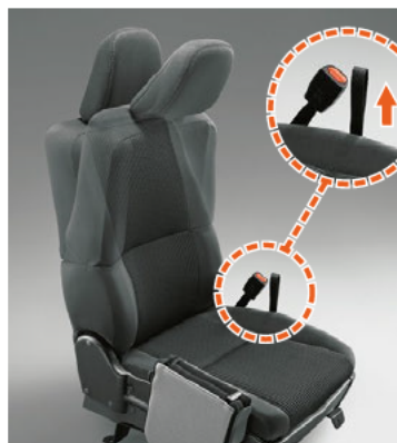
①中折れ式シートバック シート左側のストラップを引くと、背もたれの上部3分の2が前方に倒れます。背中から腰にかけてシートバックが密着し、運転姿勢に応じた角度の調整が可能です。
