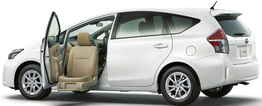
Photo: S(5人乗り) 助手席リフトアップシート車“Aタイプ”。ボディカラーのホワイトパールクリスタルシャイン(070)<30,000円>はメーカーオプション。内装色のグレージュは設定色(ご注文時に指定が必要です。指定がない場合はブラックになります)。オーディオレスカバー<1,200円(取付費が別途必要)>は販売店装着オプション。
