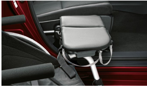
②移乗ボード 格納されている移乗ボードを外側に開き、車いすに固定します。車いすからシートへの乗り移りをサポートします。 車いす固定用ストラップ 移乗しやすいように車いすを固定するためのストラップです。
