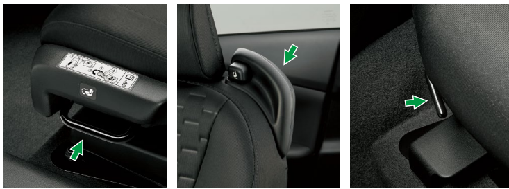
①回転スライドレバー ②チルトボタン&グリップ ③スライドレバー 運転席側からも前後スライド操作が可能です。
