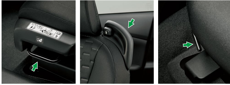
①回転スライドレバー ②チルトボタン&グリップ ③スライドレバー
