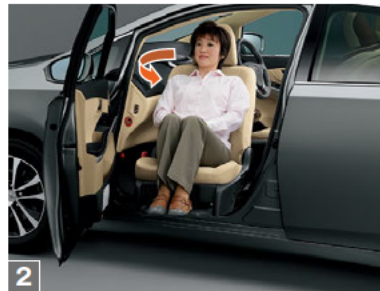
2 シートは、背もたれが倒れながら外側に回転します。
