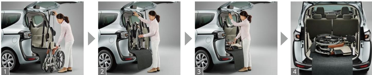
1 サードシートを格納し、ガードマットを取り付けます。収納装置のアームを車外に向けてから起こして、吊りベルトを車いすに掛けます。
