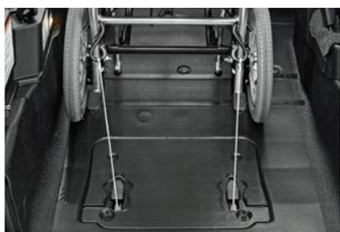
⑦後側の車いす固定装置(電動)のフックを取り出し、車いすの後部フレーム(左右2ヶ所)に掛け、車いす固定装置スイッチを押し、車いすの後部を締め付け、しっかり固定してください。
