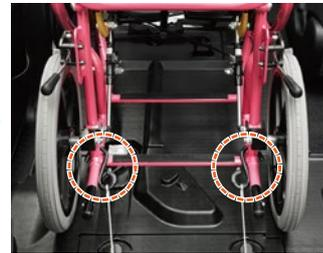
⑥車いすの後部フレーム(左右2ヶ所)に車いす固定装置(1.5列目用)のフックを取り出し掛けます。
