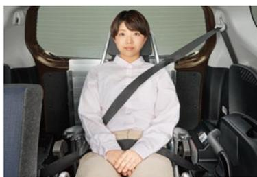
⑧車いす用シートベルトを着用します。スロープを格納し、車高調整スイッチの「上」を押し、車高復帰させます。
