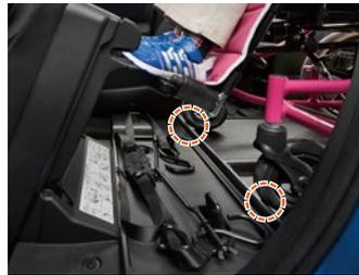
⑤車いすの前輪接地部に、フロアの車止めがあたる所で車いすのブレーキをかけます。
