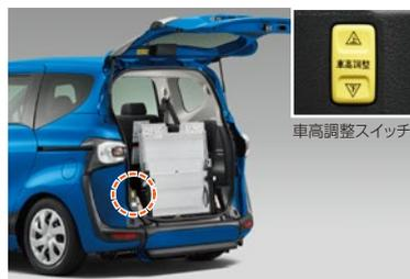
②バックドアを開け、車高調整スイッチの「下」を押します。
