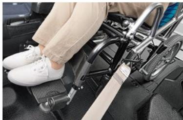
⑥車いすの後輪中央を床面の車いす停止目安線に合わせ、車いすのブレーキを掛けます。セーフティベルトにより、車いす前側が固縛されます。
