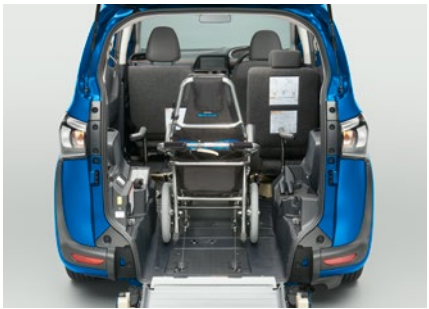
※車いす固定状態。
