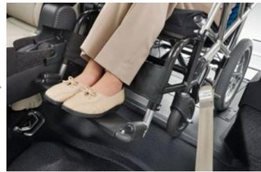
⑥車いすの後輪中央が固定目安線を約5cmほど越えた位置で停止します。セーフティベルトにより、車いすの前側が固定されます。
