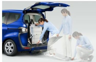
③スロープが前倒れ状態になっている場合は垂直に起こします。スロープを支えながら、ロック解除レバーを引き上げてロックを解除し、スロープの取っ手を持って車外へ引き出します。
