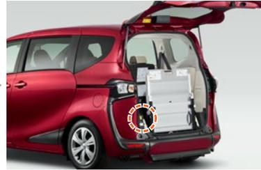
②バックドアを開け、車高調整スイッチの「下」を押します。
