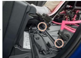
⑤車いすの前輪接地部に、フロアの車止めがあたる所で車いすのブレーキをかけます。
