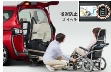
④セーフティベルトを引き出し、フックを車いすのキャスター上部(左右2ヶ所)に掛けます。後退防止スイッチの“作動”を押します。
