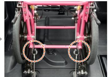
⑥車いすの後部フレーム(左右2ヶ所)に車いす固定装置(1.5列目用)のフックを取り出し掛けます。
