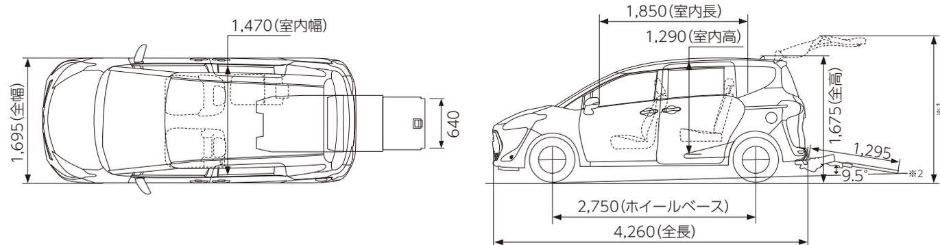
\*1 バックドア開放時の、地上からのバックドアの高さはベース車と同じです。 \*2 車高降下時の地上線です。
