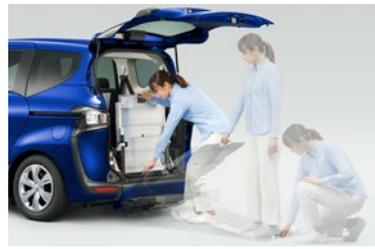
③スロープが前倒れ状態になっている場合は垂直に起こします。スロープを支えながら、ロック解除レバーを引き上げてロックを解除し、スロープの取っ手を持って車外へ引き出します。
