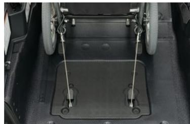
⑦後側の車いす固定装置(電動)のフックを取り出し、車いすの後部フレーム(左右2ヶ所)に掛け、車いす固定装置スイッチを押して車いすを固定します。その後、車いすのブレーキをかけます。
