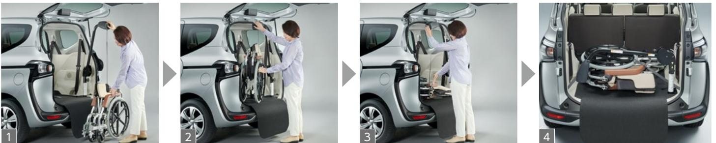
1 サードシートを格納し、ガードマットを取り付けます。収納装置のアームを車外に向けてから起して、吊りベルトを車いすに掛けます。
