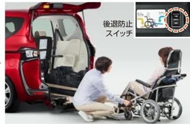
④セーフティベルトを引き出し、フックを車いすのキャスター上部(左右2ヶ所)に掛けます。後退防止スイッチの“作動”を押します。
