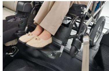
⑥車いすの後輪中央が固定目安線を約5cmほど越えた位置で停止します。セーフティベルトにより、車いすの前側が固定されます。
