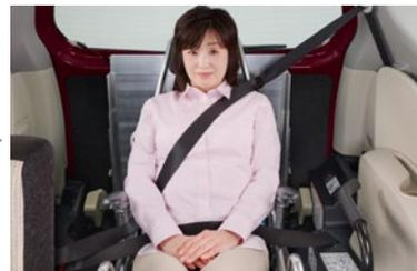
⑧車いす用シートベルトを着用します。スロープを格納し、車高調整スイッチの「上」を押して、車高復帰させます。(上がりきると自動停止します)
