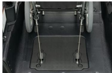
⑦後側の車いす固定装置(電動)のフックを取り出し、車いすの後部フレーム(左右2ヶ所)に掛け、車いす固定装置スイッチを押して車いすを固定します。その後、車いすのブレーキをかけます。
