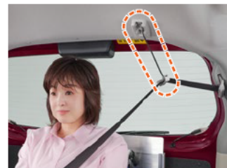
シートベルトリルータ シートベルトを適正な位置に装着するための補助装置です。
