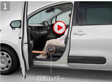
前後スライドレバーを引き上げて、シートを回転開始位置(マーク位置)までスライドさせると、自動で停止し、回転レバーがポップアップします。
