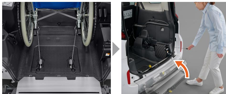
⑦後側の車いす固定装置（電動）のフックを取り出し、車いすの後部フレーム（左右2か所）に掛け、車いす固定スイッチを押して車いすを固定します。車いす用シートベルトを着用します。
