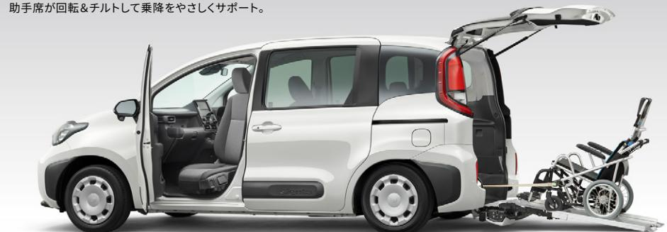
※写真はX(ガソリン・2WD)車いす仕様車“タイプI”(助手席側セカンドシート付)にメーカーオプションのターンチルトシート(助手席)を装着しています。
