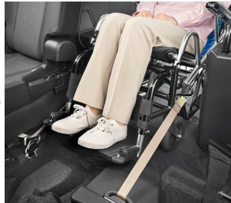
⑥車いすの後輪中央を床面の車いす停止線に合わせ停止します。セーフティベルトにより、車いすの前側が固定されます。
