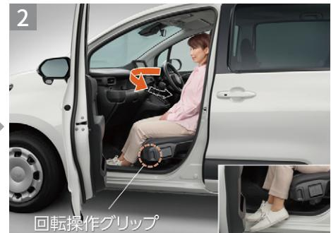
回転レバーを引き、回転操作グリップを持って、シートを外側へ回転させます。中間ロック位置まで回転させたら、介助の方が両足を支えて車外へ出します。
